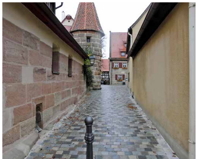
Der Kirchenvorplatz vor und nach der Neugestaltung. Der marode Asphalt wurde durch Granitgroßpflaster ersetzt
