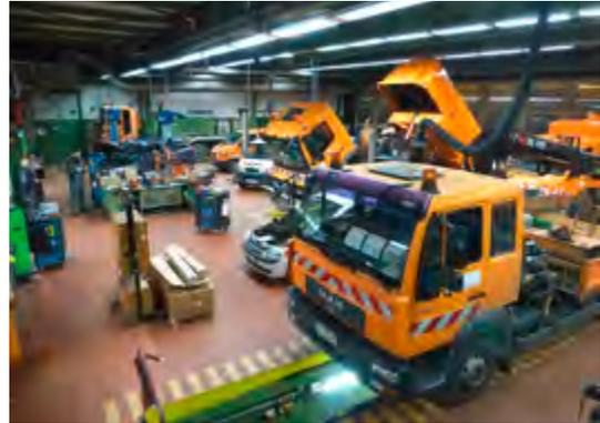
Für jedes Fahrzeug, jedes Fabrikat oder jede Marke ist eigenes Know-how gefragt. So haben sechs Mitarbeiter zum Beispiel einen Sprengstoffschein. Sie überprüfen und reparieren Airbag-Anlagen und tauschen bei Bedarf Airbag und Gurtstraffer aus.
