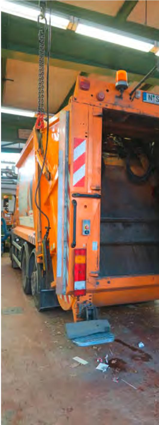
Die 80 Lkw der Müllabfuhr werden oft in der Schnellwerkstatt – angesiedelt direkt in der Müllverbrennungsanlage – bedient. Alle fünf bis sechs Jahre ist der Boden des Ladewerks verschlissen. Dann wird die „Schmiede“ – Team 3 der SÖR-Werkstatt – tätig und erneuert den Boden.
