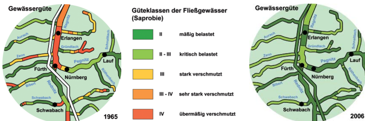
Die positive Entwicklung der Gewässergüte im Nürnberger Raum ist zum Großteil auf die Verbesserung der Abwasserreinigung und die Speicherung von Abwasser in Regenbecken zurückzuführen.
