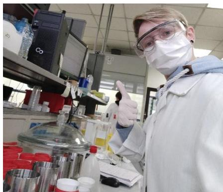
Arbeiten an der Filtrationsstation. Hier wurden ausgeheizte Filter vorgewogen und anschließend eine definierte Menge an Probe filtriert. Nach erneutem Trocknen werden die Filter nochmals ausgewogen und die Menge an abfiltrierbaren Stoffen bestimmt.
