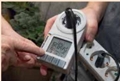
Mit einem Strommessgerät, kann der Energieberater den Verbrauch eines Elektrogerätes überprüfen.
