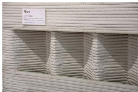
↗ Gedruckte einzelne Schichten werden zur tragfähigen Wand
