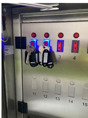
Die hinterlegten Schlüssel sind fest mit dem Einstechmechanismus verbunden und können nicht getrennt werden.
