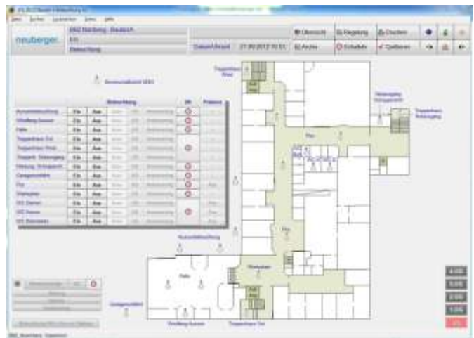
Bild 3: Die neue Gebäudeleittechnik (Quelle: Firma Neuberger)
