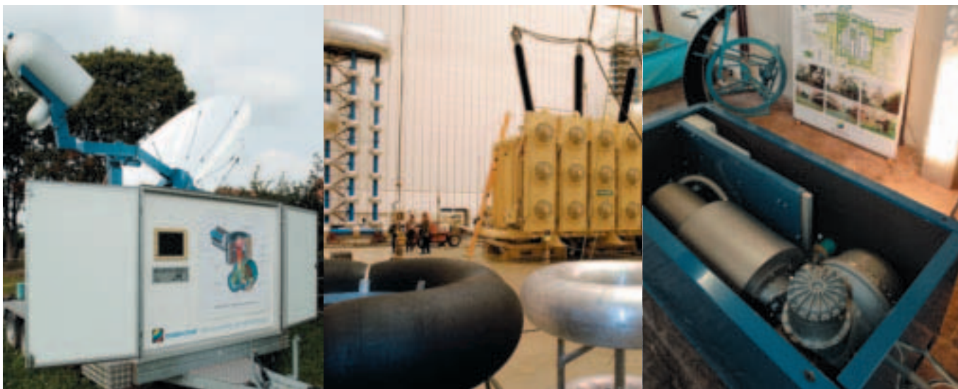
Facettenreiche Technik: Parabolspiegel für die „sunmachine“ (links), Prüfanlage des Trafowerks von Siemens (Mitte), Heizanlage mit Stirling-Motor (rechts).
