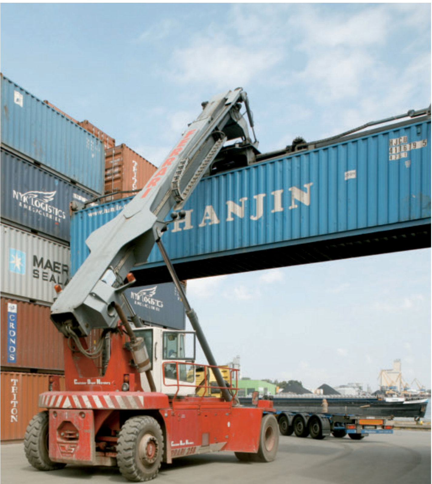
Container im Griff: Der Riesenstapler mit langem Teleskoparm (in der Branche „Reach Stacker“ genannt) sorgt für schnelles Umladen.
