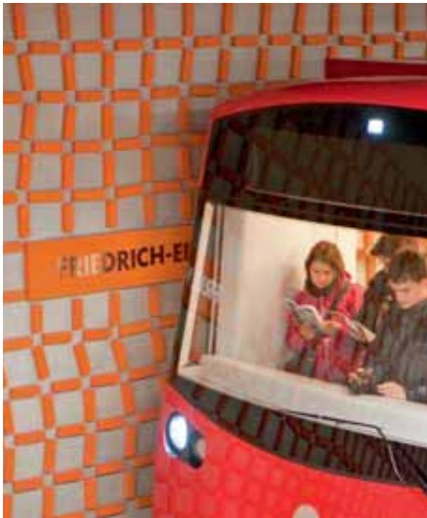
**Kunst trifft auf Funktionalität:** Die charakteristische, gepixelte Wandgestaltung taucht den Bahnhof in ein orange-rot-farbenes Netz. Innerhalb von vier Wochen sind entlang des Bahnsteigs über 30 000 einzelne Pixel-Fliesen verlegt worden. Sie bestehen aus Glasgranulat und sorgen damit für Schalldämmung.
