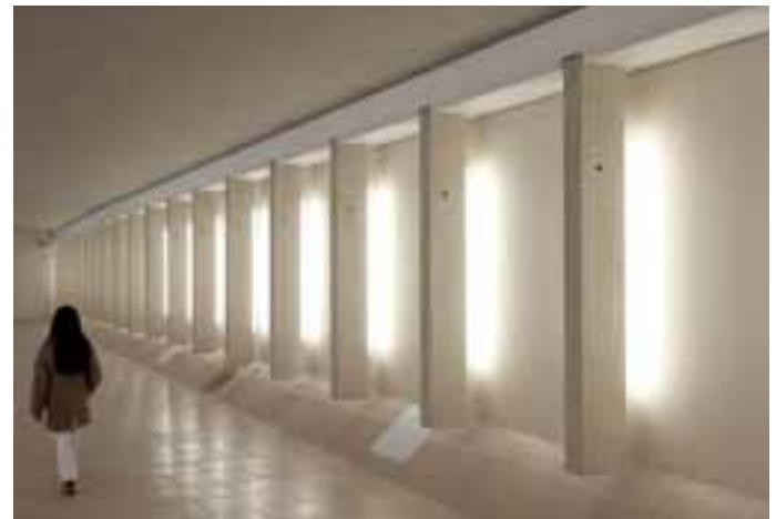
**Ein Spiel mit Kunst- und Tageslicht:** Das reduziert mit Betonelementen gestaltete Zwischengeschoss wird durch den Einsatz verschiedener Lichtquellen und den Einfall von Tageslicht bei den U-Bahn-Zugängen in Szene gesetzt. Die frei-hängenden Betonstelen im Verteilergeschoß sind hinterleuchtet und erzeugen so ein Lichtband, das den Raum erhellt.
