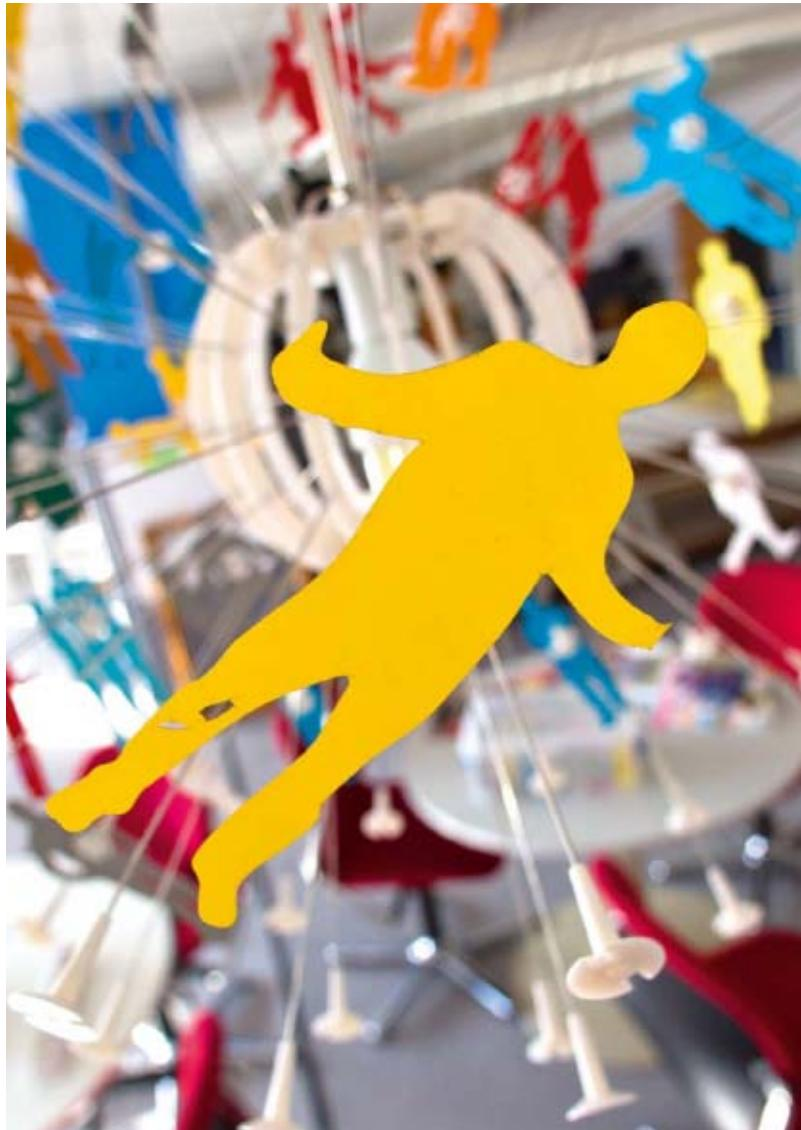
**Tüfteln im Elektronik-labor:** Die Silhouetten-Lampe ist das Ergebnis eines Teambuilding-Workshops im Fab Lab Nürnberg. Die Teilnehmer wurden mit einer Webcam fotografiert, ihre Umrisse mit einem Laser-cutter aus Kartonpapier ausgeschnitten und auf eine handelsübliche Ikea-Lampe geklebt. Ob 3D-Drucker, Lasercutter oder Folienschneider – die Hightech-Geräte der offenen Werkstatt sind kostenlos zugänglich.
