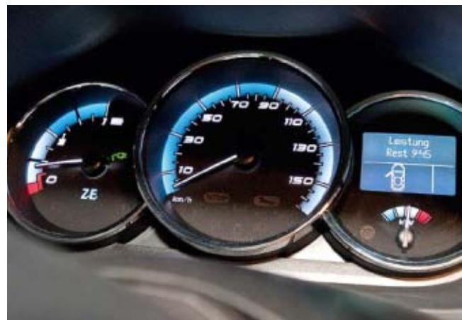
Ein markanter Unterschied zum Verbrennungsmotor ist der Anschluss für das Strom-Ladekabel. Beim Tacho zeigt das grüne Stecker-Symbol, wann wieder „getankt“ werden muss.
