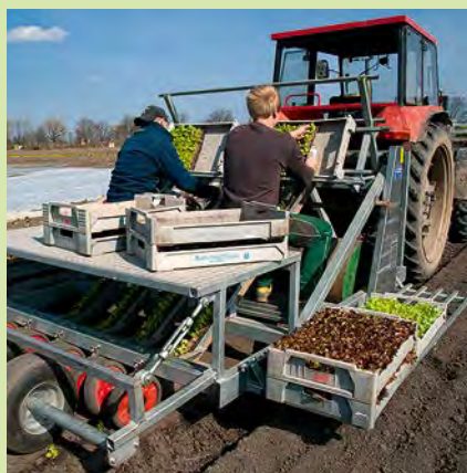
Von zwei Männern bedient, setzt ein Schlepper mit Pflanzgerät die kleinen Freiland-Salate in den Acker.
