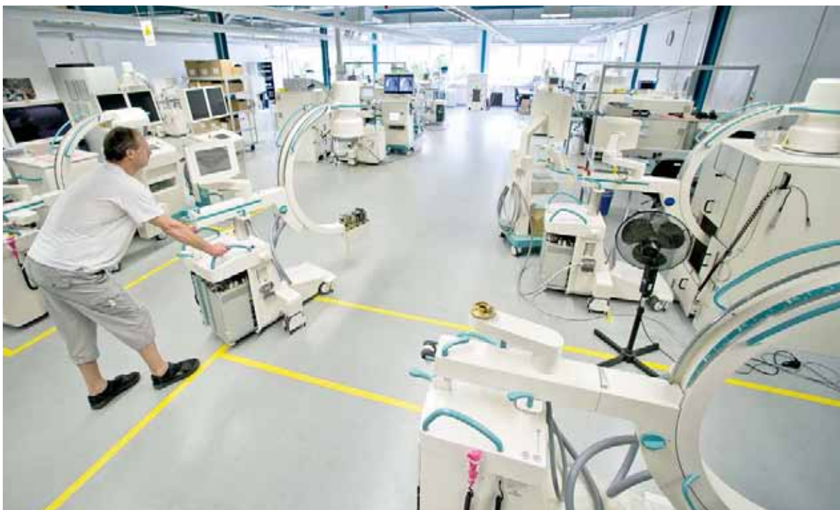
Sind die C-Bögen zusammengesetzt und alle Bestandteile montiert, geht's zur Endkontrolle. Georg Kreuzer schiebt ein Gerät zum Systemtest. Ist der bestanden, wandert es weiter in die Versandabteilung.
