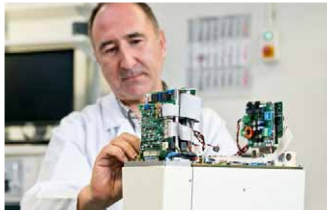
Die Generatoren sind das Herzstück eines jeden C-Bogens. Der Teamleiter der Generatorenabteilung, Markus Kolat, checkt einen Generator auf Herz und Nieren, bevor er die Röhre einsetzt.
