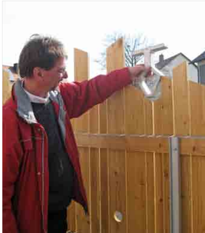
Peter Bechert bei der Prüfung einer „Halsfangstellte“ am Zaun eines Kindergartens
