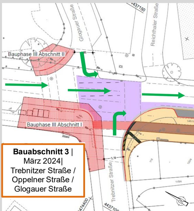
Der bestehende Fußgängerübergang an der Kreuzung wird behindertengerecht ausgebaut. Die anliegenden Fahrspuren sind während der Arbeiten eingeschränkt nutzbar. Der Fußverkehr wird vorbeigeführt.
