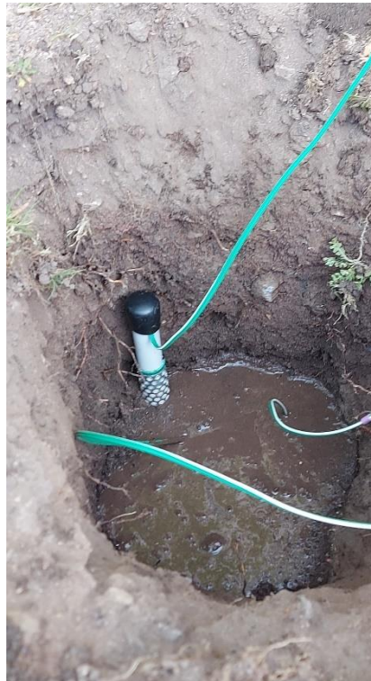
Bild 11: Einbau des Sensors zur Messung der Saugspannung im Boden
