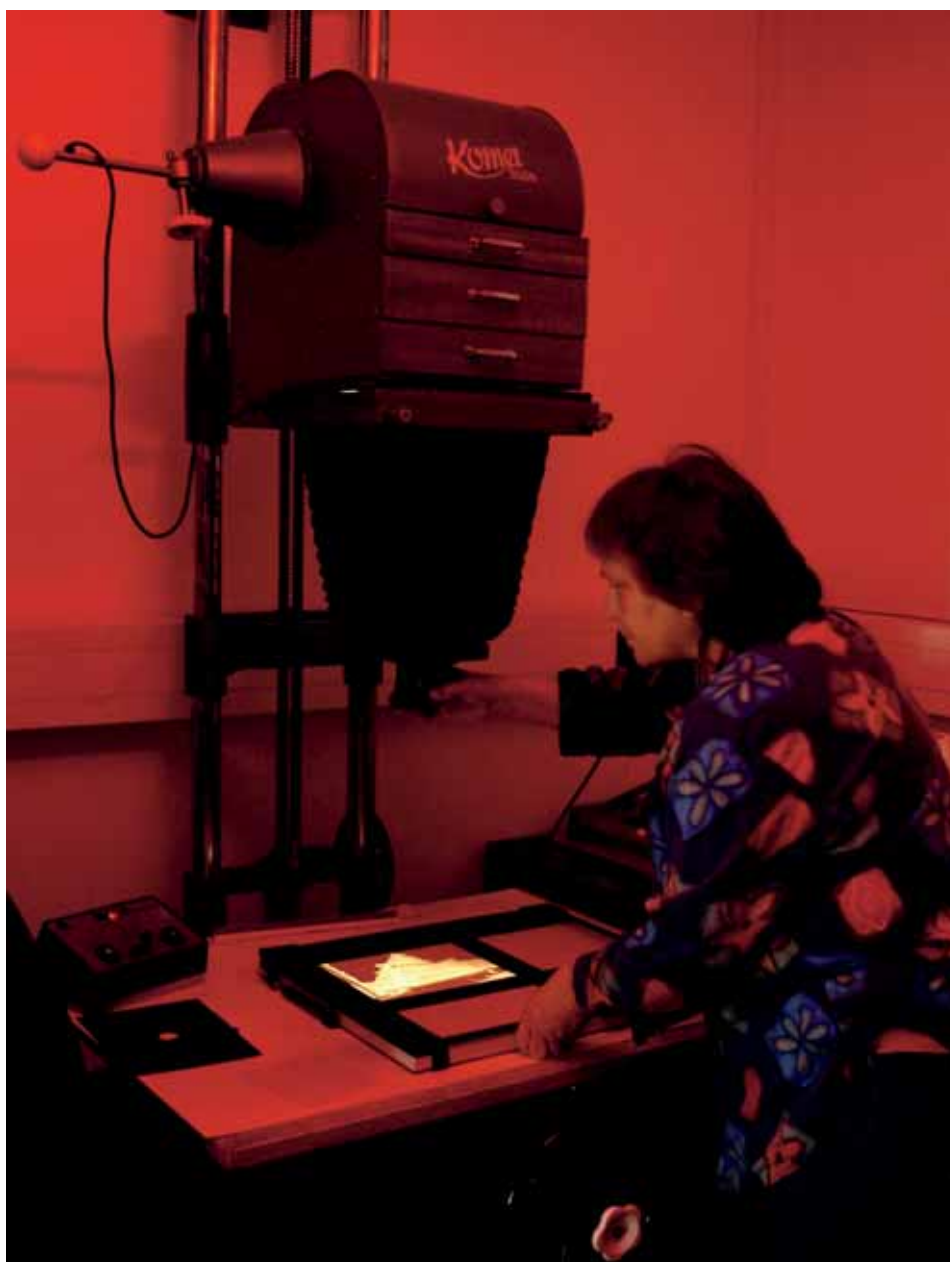
Lebendige Technikgeschichte im Stadtarchiv: Frau Walthier bei der Bedienung der „Komet 300 N“, keinem künstlichen Erdrabanten vor dem Abschuss, sondern einer Kamera für Glasplattennegative.
