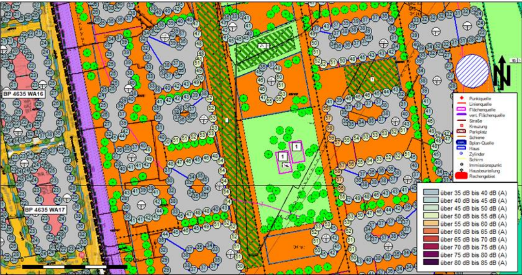
Abbildung 13. Lage der Schallquellen der Sportanlagen sowie resultierender höchster Beurteilungspegel über der Fassade in dB(A) bei Dauerbetrieb der Anlagen.
