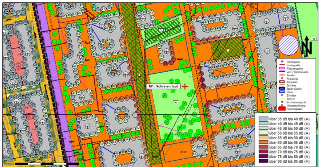
Abbildung 15. Lage der Schallquelle, kurzzeitige Geräuschspitzen (rotes Kreuz) sowie resultierender höchster Maximalpegel über der Fassade in dB(A).
