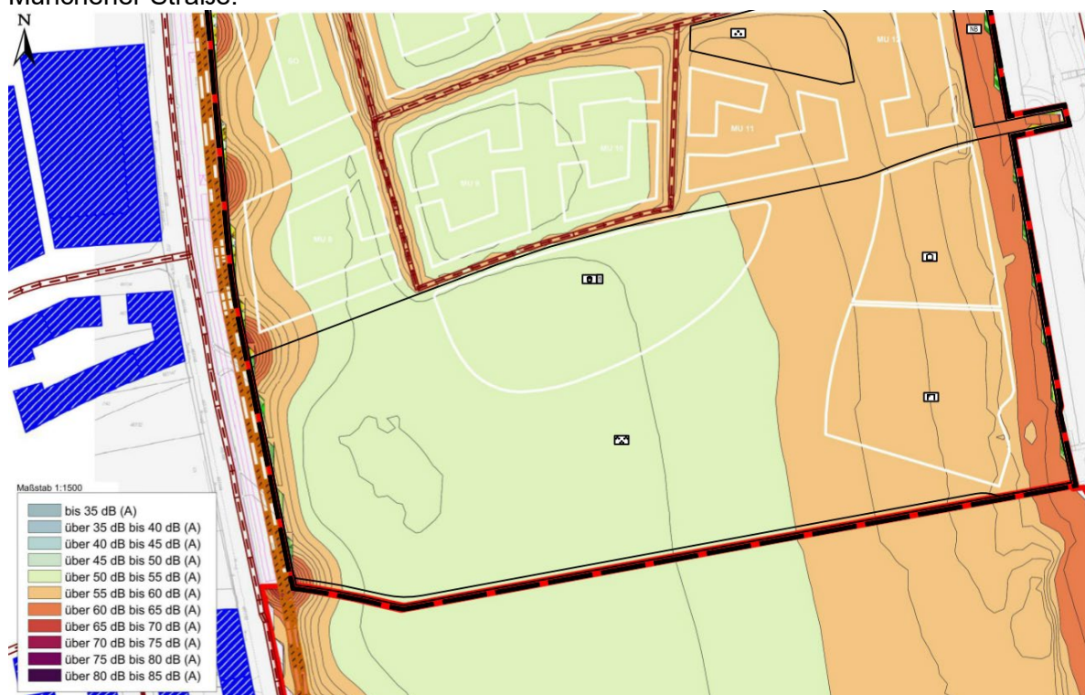
Abbildung 5: Einwirkung des Verkehrslärms auf den Park auf 2 m Höhe Quelle: MBBM, München; eigene überlagerte Darstellung
