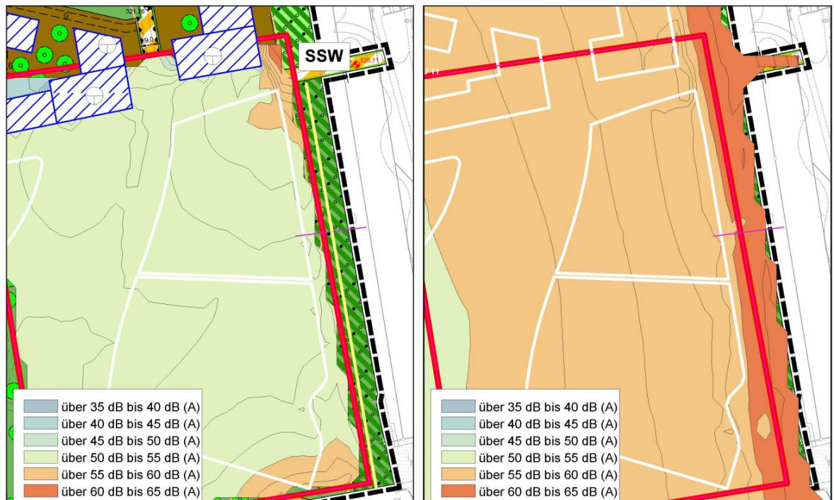
Abbildung 6: Schalltechnische Situation mit Schallschutzwand (gelbe Linie) und ohne Schallschutzwand Quelle: MBBM, München
