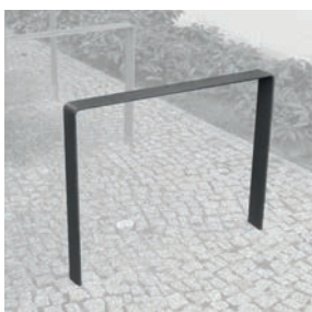
Fahrrad-Anlehnbügel Kreuzberger Bügel III , Fa. Abex, Flachstahl 60/12 mm, Breite 800 mm, abger. Ecken, dunkelgrau in Ensembleschutzgebiete und bei hoher Einzeldenkmaldichte
