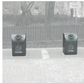
Unterflurbehälter für Glas, verschiedene Anbieter. Vorteile: behindertengerechte Einwurfsäule, erhöhte Sauberkeit, kaum Geräusentwicklung
