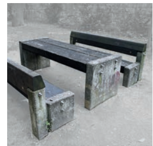
Bank mit »Halbstämmen« und Betonfüßen, auch als Tisch-Bank-Kombination Bestandsschutz, Verwendung in Spielanlagen
