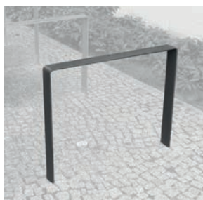
Fahrrad-Anlehnbügel Kreuzberger Bügel III, Fa. Abex, Flachstahl 60/12 mm, Breite 800 mm, abger. Ecken, dunkelgrau in Ensembleschutzgebieten und bei hoher Einzeldenkmaldichte
