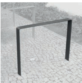
Fahrrad-Anlehnbügel Kreuzberger Bügel III , Fa. Abex, Flachstahl 60/12 mm, Breite 800 mm, abger. Ecken, dunkelgrau Vorzugstyp für Ringstraße, Ensemble- schutzgebiete und bei hoher Einzel- denkmaldichte
