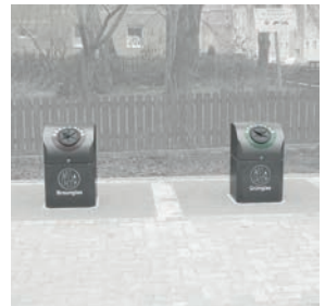
Unterflurbehälter für Glas, vers. An- bieter. Vorteile: behindertengerechte Einwurfsäule, erhöhte Sauberkeit, kaum Geräuscentwicklung
