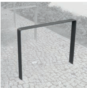
Fahrrad-Anlehnbügel Kreuzberger Bügel III , Fa. Abex, Flachstahl 60/12 mm, Breite 800 mm, abger. Ecken, dunkelgrau
