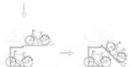
Funktionsschema Fahrrad-Parksystem mit Hebermechanismus M 1:50
