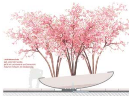
Detail ohne Maßstab: Kirschscheibe aus Faserbeton
