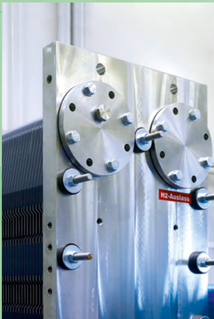
Teilausschnitt eines Elektrolyseurs mit Wasserstoff-Auslass.
