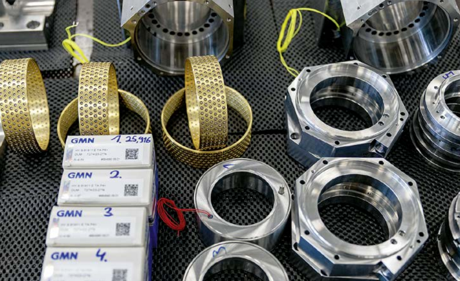
Verschiedenste Bauteile und hochpräzise GMN-Kugellager werden auch zur Herstellung von Spindeln benötigt.
