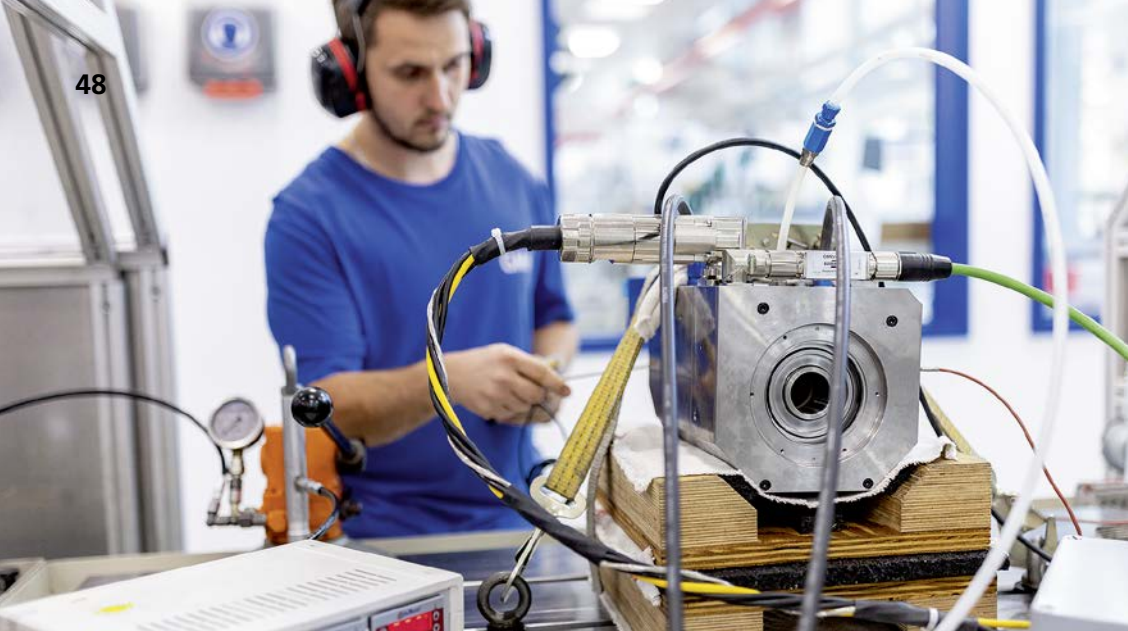
Am Prüfstand testet Mechatroniker Daniel Meyer eine Spindel über alle Drehzahl-, Temperatur- und Druckbereiche.
