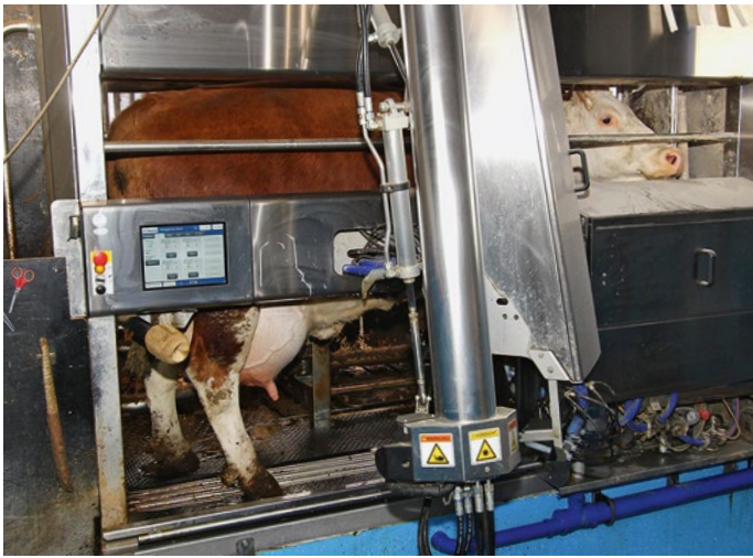
Vollautomatisch und rund um die Uhr: Der Melkroboter ist das Herzstück im Stall.
