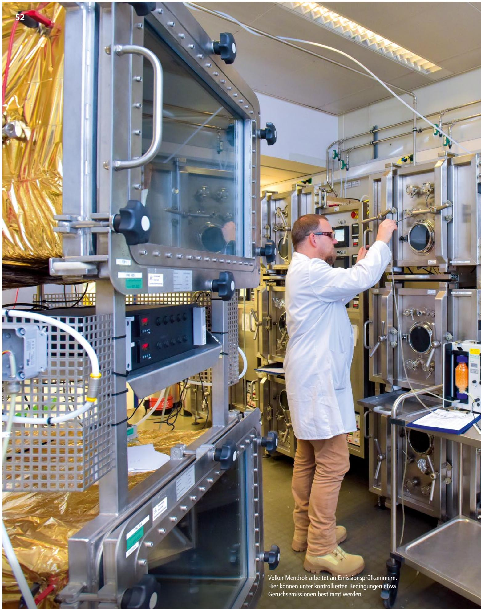
Volker Mendrok arbeitet an Emissionsprüfkammern. Hier können unter kontrollierten Bedingungen etwa Geruchsemissionen bestimmt werden.
