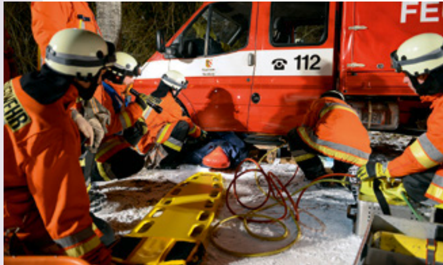
Bergung einer unter einem Fahrzeug eingeklemmten Person mit aufblasbaren Luftpolstern und Trage. *
