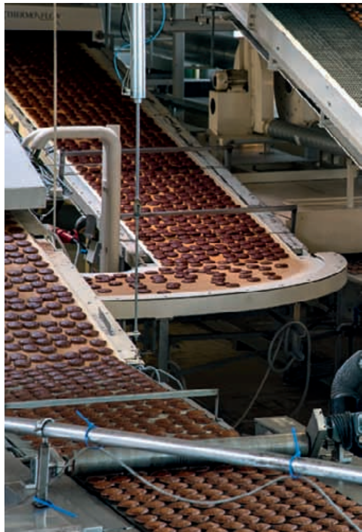
Hunderte Fließband-Meter legen Lebkuchen in der Fabrik von Schmidt zurück: über Trockenbänder, durch Ofenlinien und Schokoladenvorhänge.
