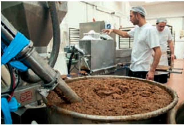
Ist der Teig fertig gerührt, wird er abgesaugt und in kleinen Portionen auf Oblaten gestrichen.
