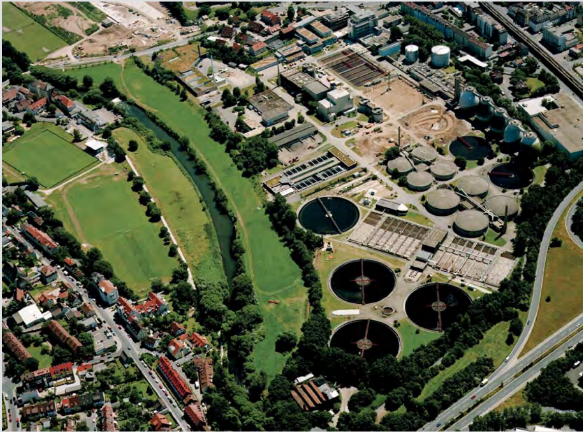
Das Klärwerk 1 im Jahr 1999. Die Tropfkörper werden abgebrochen, eine neue erste biologische Stufe entsteht.
