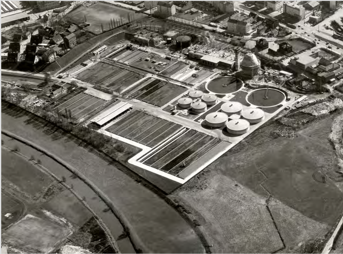
Das Klärwerk 1 im Jahr 1966. Biologische Reinigung in Tropfkörpern, großflächige Trockenbeete. Der erste große Faulbehälter entsteht.
