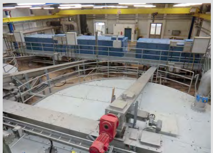
Die neue Schlammentwässerungsanlage im Klärwerk 1. Die Entwässerung findet in Zentrifugen statt, die im Hintergrund zu sehen sind.
