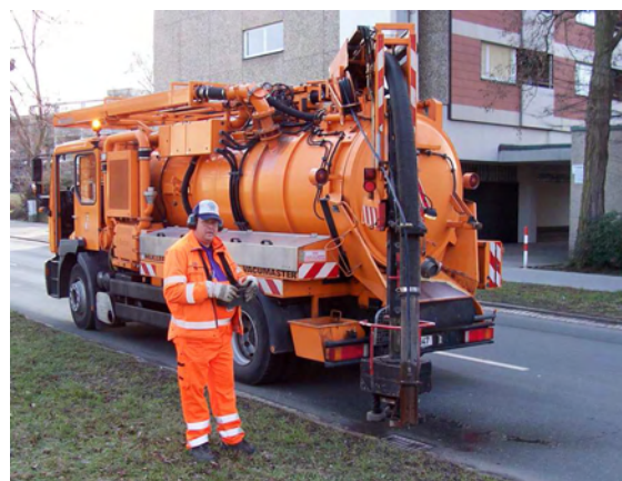
Die Reinigung von Regeneinläufen auf öffentlichen Straßen erfolgt mit dem hier gezeigten Spezialfahrzeug.
