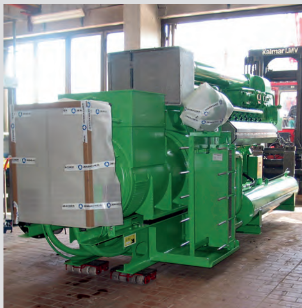
Eines der beiden Blockheizkraftwerke im Klärwerk 1 bei der Anlieferung, fotografiert im Jahr 2011. Foto: SUN.
