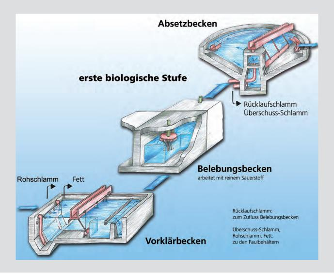
Das Klärwerk 1 hat zwei biologische Reinigungsstufen. Die **erste biologische Stufe** entfernt den größten Teil der Kohlenstoffverbindungen aus dem Abwasser. Damit die Bakterien besser arbeiten und schlechte Gerüche vermieden werden, wird hier reiner Sauerstoff verwendet. Deshalb sind die Belebungsbecken abgedeckt.
