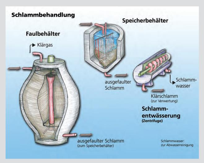
Die Zeichnungen zeigen schematisch die Funktionsweise der Kläranlage. Sie sind jedoch nicht in allen Fällen ein genaues Abbild der Bauwerke im Klärwerk 1.
