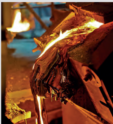
Und so sieht es aus: Abfließende Schlacke an einem Kupolofen in Sulzbach-Rosenberg. Foto: Burkard Hagspiel
