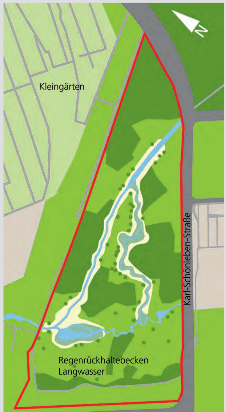
Das Regenrückhaltebecken Langwasser nach seiner Umgestaltung. Grundlage der Grafik: Planungsbüro Team 4.
