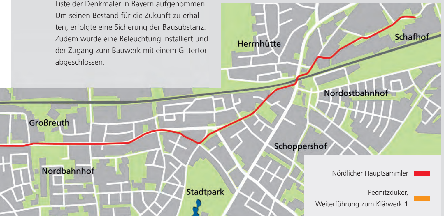
Oben: Die Hauptkanäle im Nürnberger Stadtgebiet. Rot eingezeichnet ist der Nördliche Hauptsammler. Unten: Der Verlauf des Nördlichen Hauptsammlers. Kartengrundlage: Stadt Nürnberg, Geoinformationssystem.
