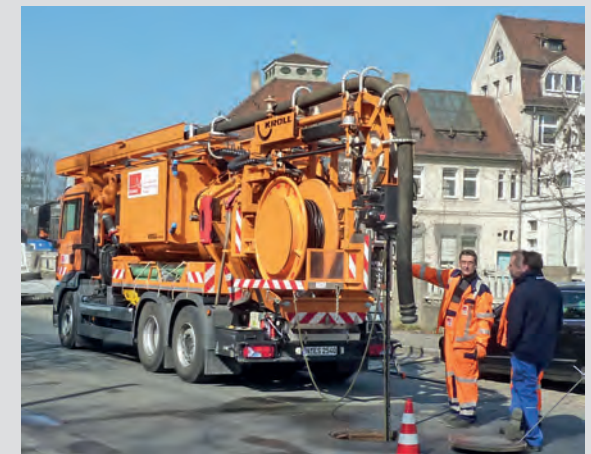
Ein Hochdruck-Spülfahrzeug für die Kanalreinigung.
