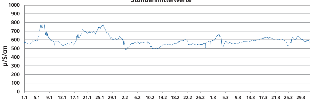
Leitfähigkeit in \mu\text{S}/\text{cm} , Messstation Neumühle Stundenmittelwerte
