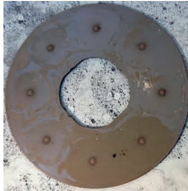
Schwebstaub-Ablagerung an der Vorabscheidung für den Staubanteil größer 2,5 µm an einer Feinstaubmessung. Foto: SUN.
