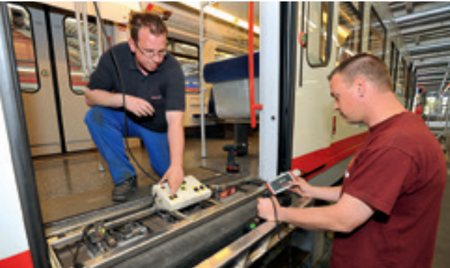
Die Funktionalität der Spaltüberbrückung wird regelmäßig in der U-Bahn-Wagenwerkstatt überprüft.
