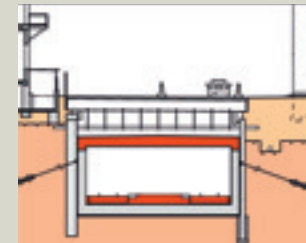
Abb.5: Betonieren der Bauwerksdecken und Betonteile der Aufgangsbereiche und des Aufzugs. Herstellen der Bahnsteigplatten und des Masse-Feder-Systems.
