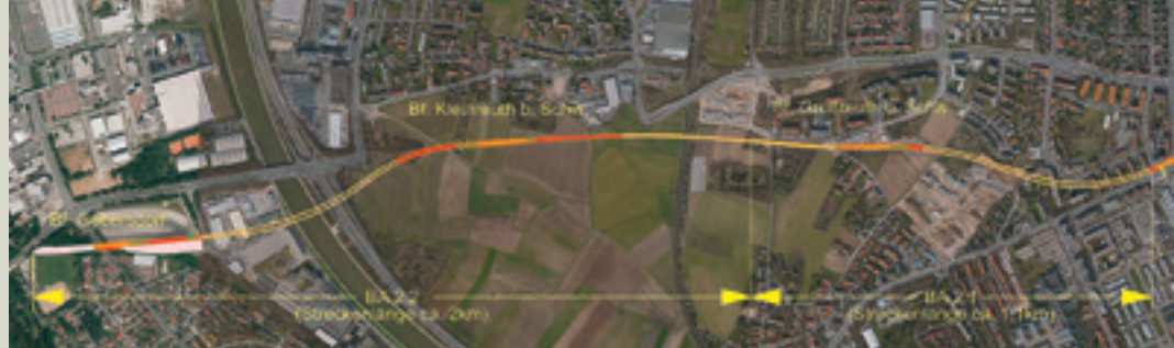
Der im Süden in Bau befindliche Bauabschnitt 2.1 umfasst den Bahnhof Großreuth bei Schweinau, der in Planung befindliche Bauabschnitt 2.2 die Bahnhöfe Kleinreuth bei Schweinau und Gebersdorf. Die Gesamtstreckenlänge beträgt etwa 3,1 Kilometer.
