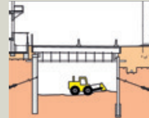
Abb.3: Aushub unterhalb der Abdeckung und Rückverankerung der Bohrträger und Bohrpfähle.
