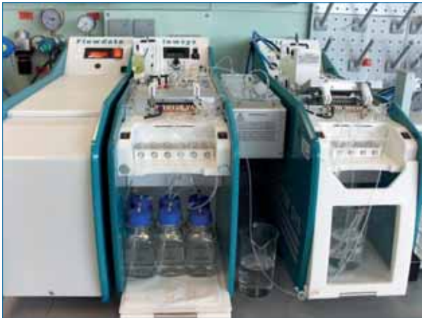
Abbildung 67: Messgerät (CFA) zur Bestimmung von Cyaniden und Phenolindex. (Quelle: Stadt Nürnberg, Stadtentwässerung und Umweltanalytik Nürnberg)
