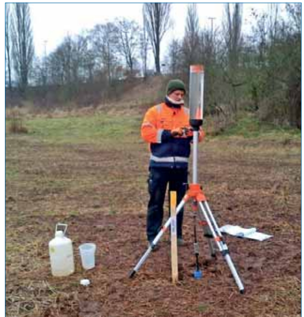
Abbildung 130: Durchführung von Versickerungsversuchen mit einem Bohrloch-Infiltrometer durch die Stadtentwässerung und Umweltanalytik (Quelle: Stadt Nürnberg, Stadtentwässerung und Umweltanalytik Nürnberg)
