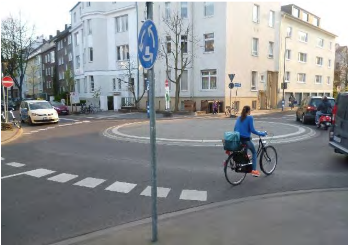
Abbildung 16: Führung des Radverkehrs innerhalb eines Minikreisverkehrs
