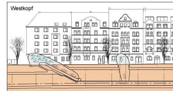
Abb. 3: Bahnhofszugang und Aufzug am Westkopf
