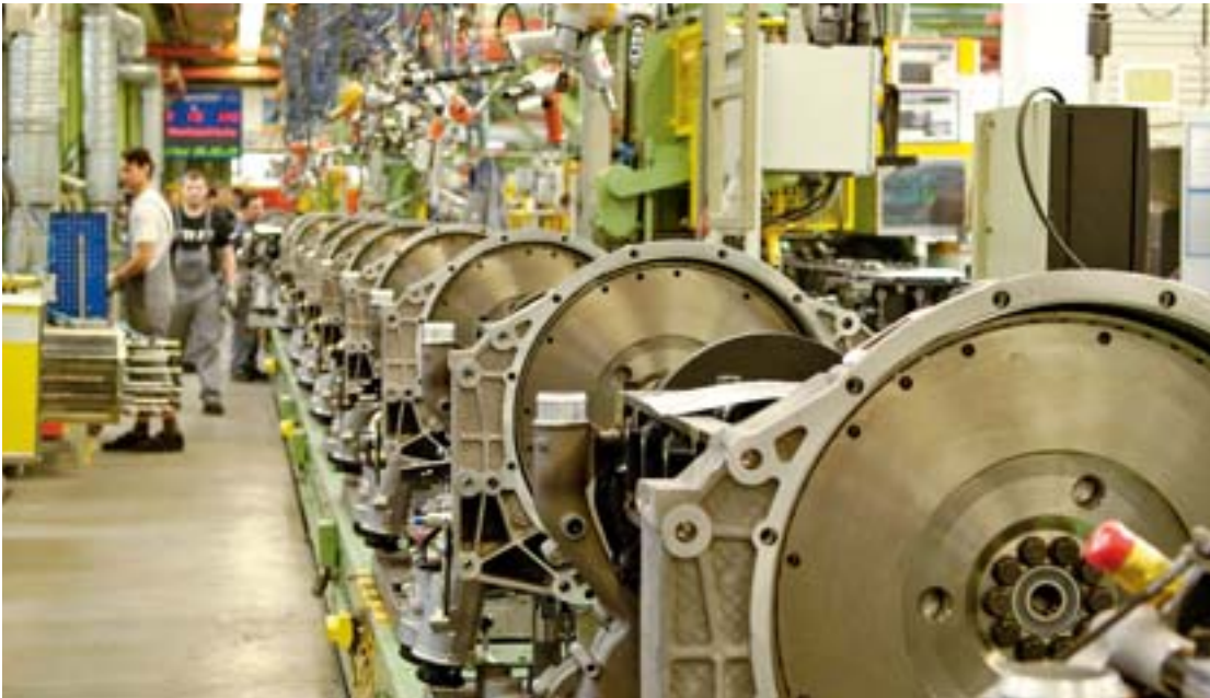
Oben: Auf dem Hauptmontageband der D20/D26-Motoren entstehen aus vielen verschiedenen Komponenten leistungsstarke Kraftpakete.
