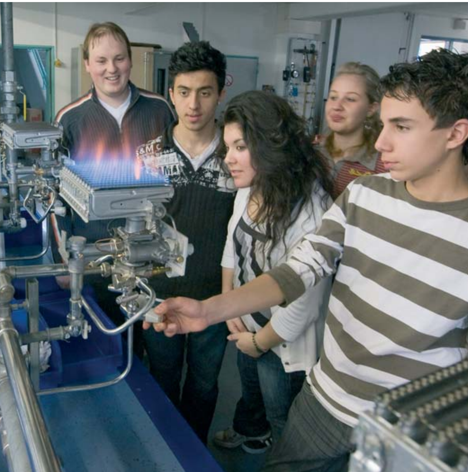
Hautnaher Praxiseinblick: Schülerinnen und Schüler erfahren in einer Lehrwerkstatt, wie ein Gasdurchlauferhitzer funktioniert. Foto: Birgit Fuder
